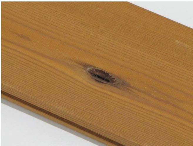
Dopuszczalne są pęcherze żywiczne.
