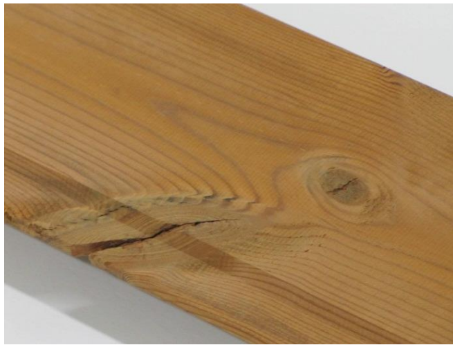
Dopuszczalne są pojedyncze pęknięcia sęków.
